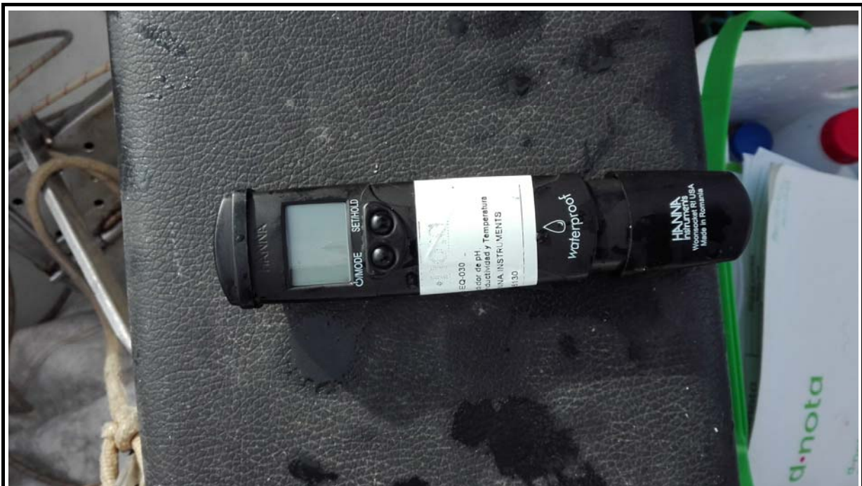
Figura 4.- Sonda de mano utilizada para realizar mediciones in situ de pH.
