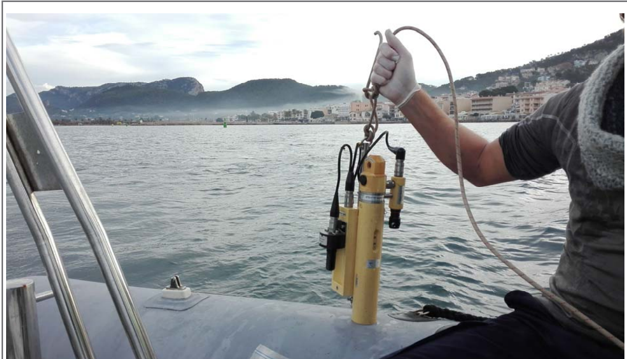
Figura 4.- Sonda multiparamétrica STD/CTD modelo SD204 para la caracterización de la presión, la temperatura, la salinidad, la turbidez, el oxígeno disuelto y la concentración de clorofilas en el agua durante la campaña de muestreo.
