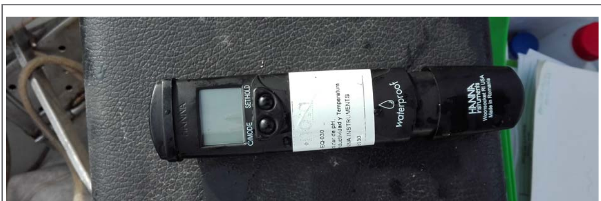
Figura 5.- Sonda de pH modelo HANNA HI98130 para la caracterización del pH superficial del agua durante la campaña de muestreo.
