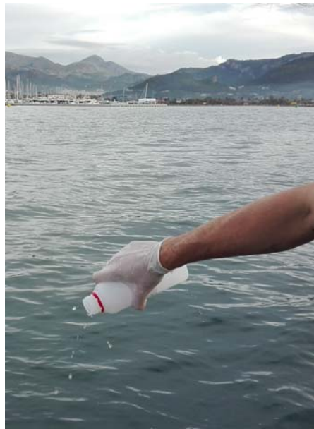
Figura 7.- Enjuague previo de recipiente de toma de muestras por parte de un técnico de dnota .
