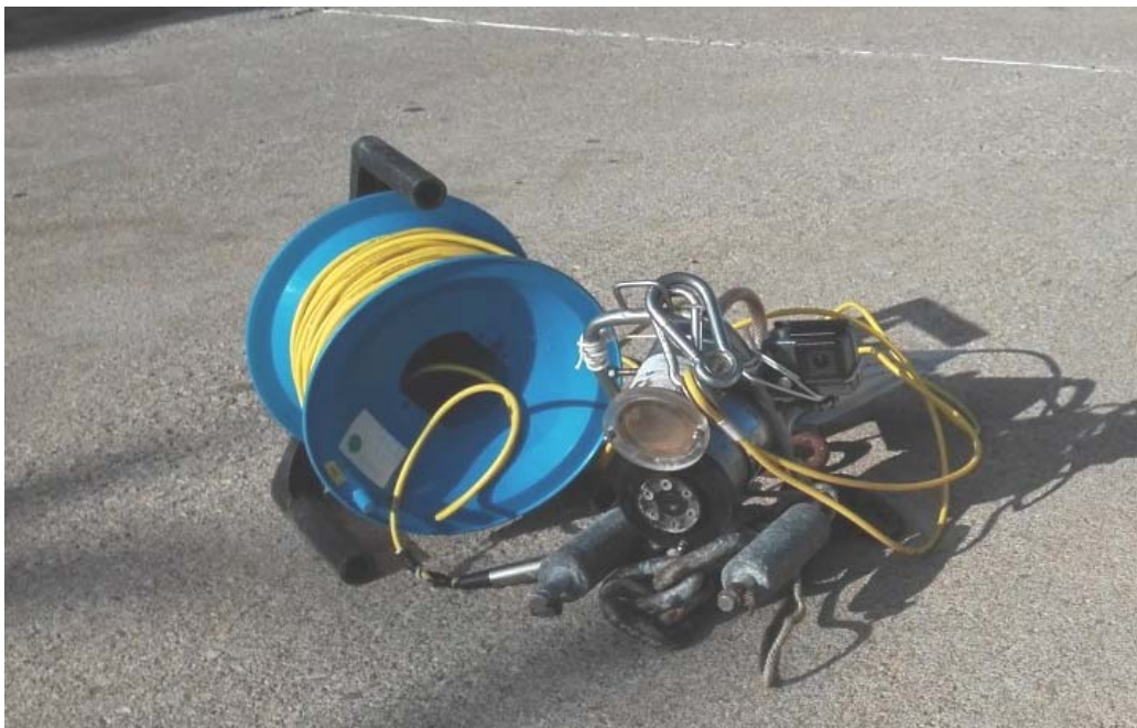
Figura 9.- Detalle de la cámara de vídeo montada sobre el patín metálico hidrodinámico.
