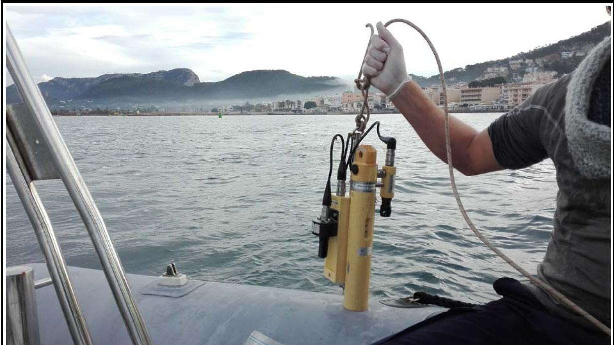
Figura 5.- Sonda CTD utilizada para llevar a cabo el estudio de calidad del agua (estructura vertical de la columna de agua).
