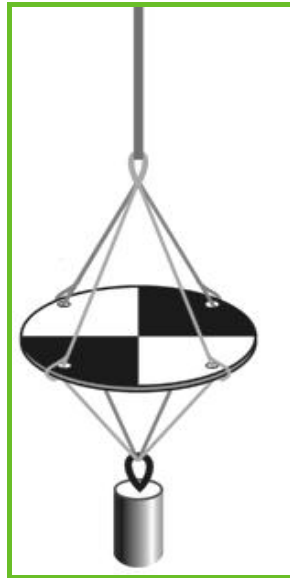
Figura 6.- Detalle de los elementos que forman parte de un disco de Secchi.
