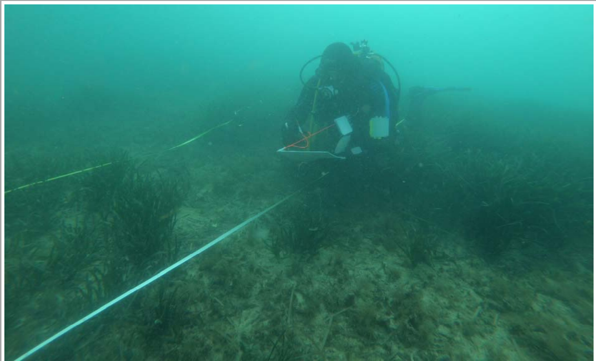
Figura 1.- Buceador realizando el muestreo de la cobertura mediante el método intercepto lineal en una de las estaciones de muestreo.
